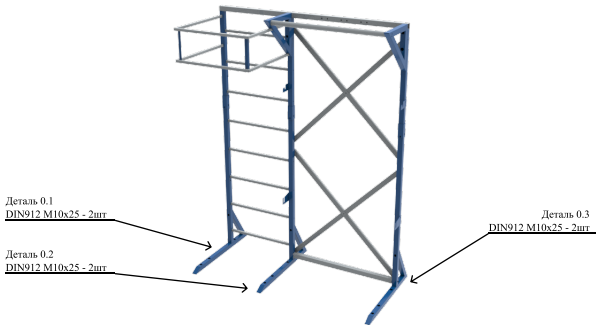
Рис. 8 – Сборка крепежей к стене и кровли
