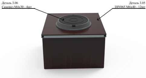
Рис. 13 – Сборка имитации кровли
